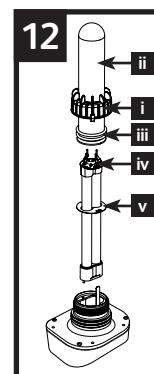
Führen Sie gegebenenfalls einen Schlitzschraubendreher in die Nuten auf beiden Seiten des elektrischen Anschlusses ein, um diesen vorsichtig vom Hauptgehäuse abzuhebeln.
