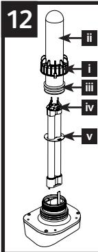
Indien nodig moet een schroevendraaier voor schroeven met platte kop in de gaten in de beide uiteinden van de elektrische kop worden gestoken, om de elektrische kop voorzichtig van het huis weg te duwen.
