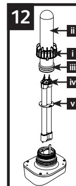
Vous pouvez insérer un tournevis plat dans les fentes de chaque côté de la tête électrique afin de soulever légèrement la tête électrique du corps principal si nécessaire.
