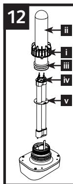
Se necessário, pode introduzir uma chave de fendas com cabeça plana nas ranhuras existentes em cada um dos lados da cabeça elétrica para elevar cuidadosamente a cabeça elétrica e afastá-la do corpo principal.
